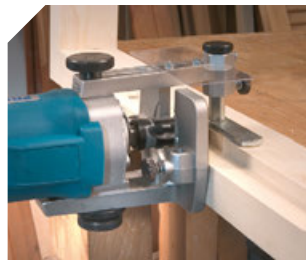
Wykonywanie felcu za pomocą frezu numer 1240046 i prowadnicy 1250041
