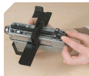
Mikrometryczne pokrętko do regulacji szerokości cięcia.
