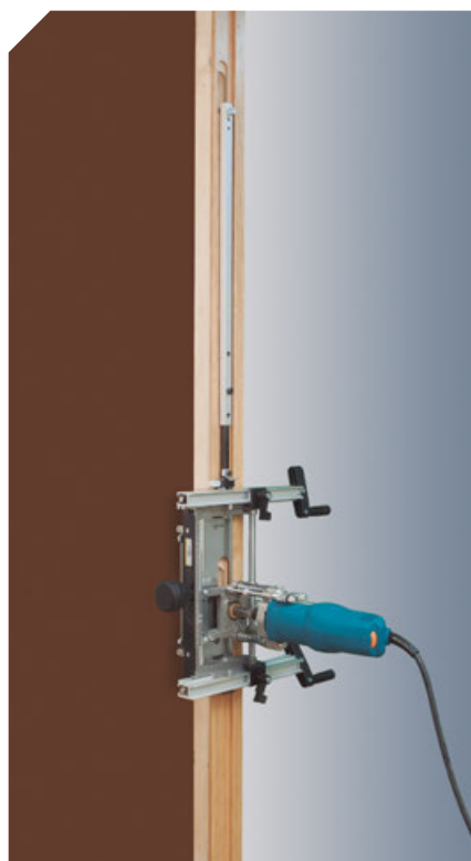
Prowadnica ułatwia skuteczne frezowanie kolejnych wgłębień pod zawiasy.
