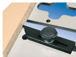
Regulowany stoper do korygowania pozycji. Pozwala skorygować kąt pomiędzy ścianą a blatem.
