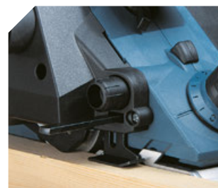
Prowadnica boczna do wręgów o głębokości do 25mm
