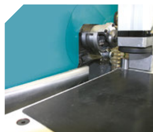
Listwa prowadząca od strony krawędzi z obrzeżem, które ma być.
