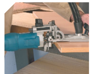
Frezowanie z zastosowaniem frezu prostego.
