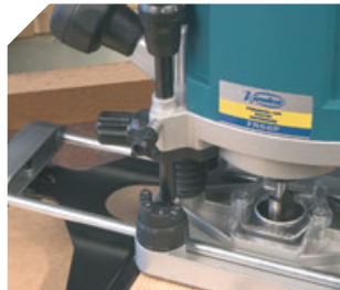
Błyskawiczne ustawienie sześciu pozycji głębokości.
