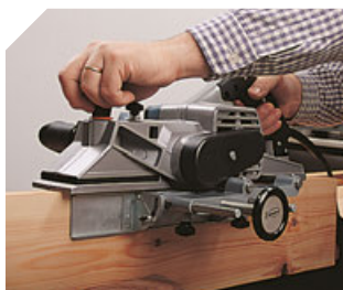
Mikrometryczna prowadnica umożliwiająca struganie krawędzi pod różnymi kątami.
