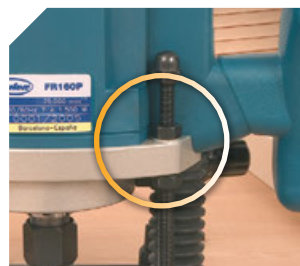
Blokada głębokości zagłębienia frezarki.
