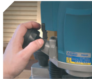
Włącznik blokady głowicy można uruchomić z pokrętła zapewniając całkowitą kontrolę i bezpieczeństwo.
