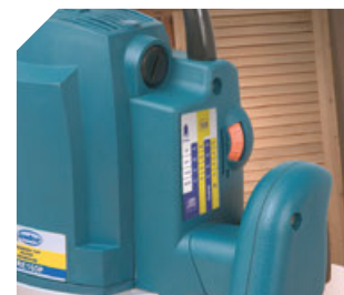
W modelu FRE160P występuje elektroniczna kontrola prędkości i obrotów w celu zapewnienia stałej prędkości silnika przy obciążeniu.
