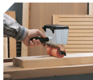
Równomierne nakładanie kleju na większe powierzchnie.
