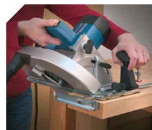
Wykonuje cięcia pod kątem.
