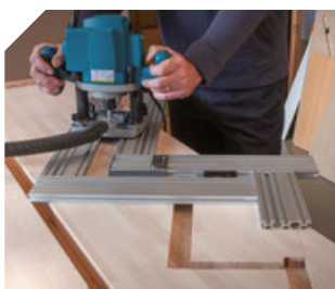
Szybkie i łatwe frezowanie zagłębień w podłużnicach.
