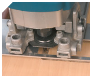
Pierścień prowadzący daje funkcje routera.
