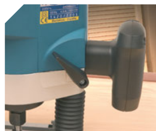
Wygodne umieszczenie blokady zagłębienia dostępne z uchwytu.
