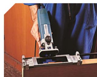
Mocowanie do drzwi. (Model AO93)
