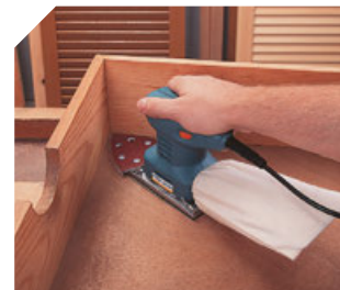
Przy użyciu podstawy w kształcie delta łatwo i szybko można szlifować narożniki.
