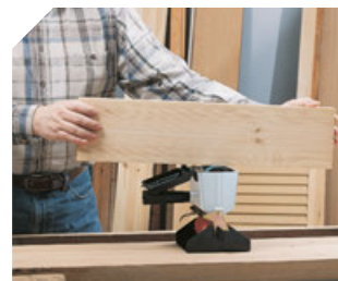
Nakładanie kleju za pomocą wałka górnego.
