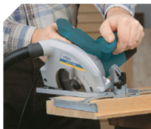
Wykonuje cięcia pod kątem.
