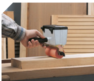
Równomierne nakładanie kleju na większe powierzchnie.
