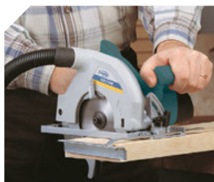
Lekka i stabilna, może wykonywać cięcia do 51 mm.
